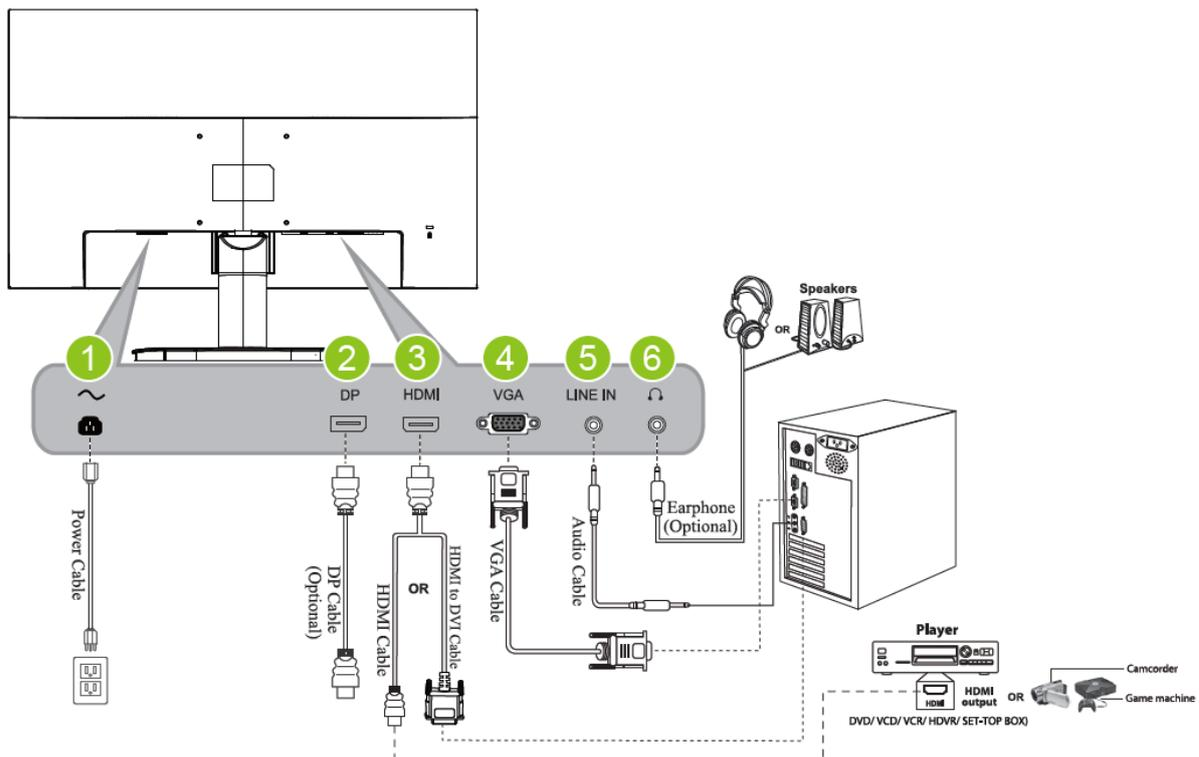
ABBILDUNG 2. ANSCHLISSEN AN EINEN PC
